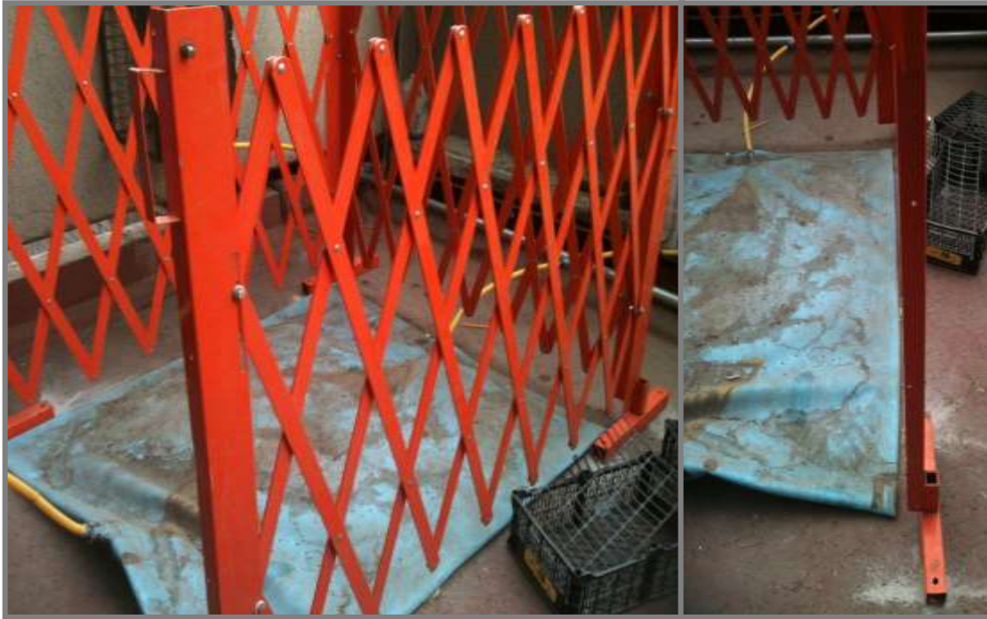
FIGURA 4.17. ESTRUCTURA PARA BOLSAS DE BIOGÁS
