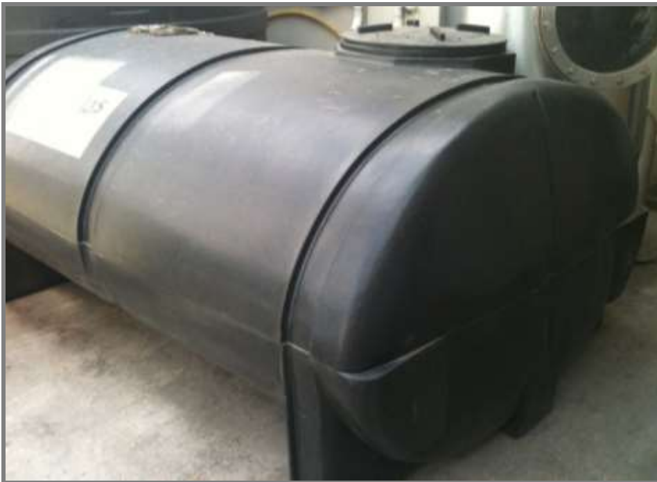
FIGURA 4.1. TANQUE PARA TRASLADO DEL INÓCULO
