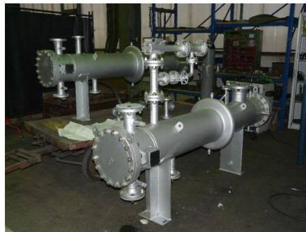
Figura 10 Condensador de vapor<sup>19</sup>
