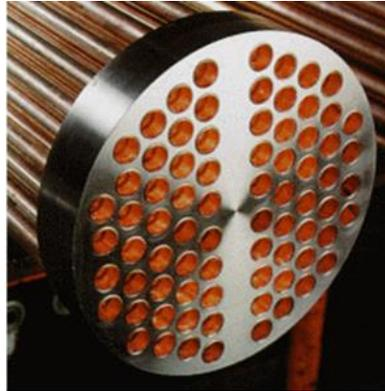
Figura 14 Placa para tubos<sup>29</sup>
