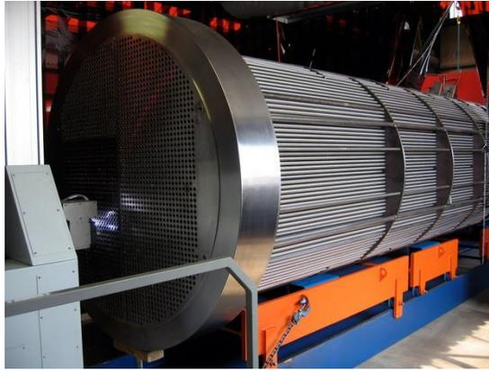
Figura 11 Condensador comercial (tubos con condensación externa)<sup>21</sup>
