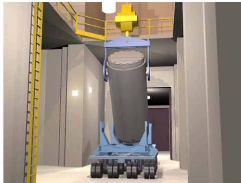
**Figura 4-7.** Levantamiento del contenedor de transferencia del tráiler
