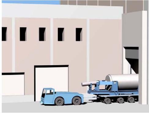
**Figura 4-6.** Entrada del contenedor de transferencia al edificio del reactor
