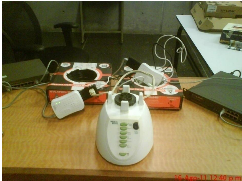
Figura 3.14. Topología física de la red PLC
