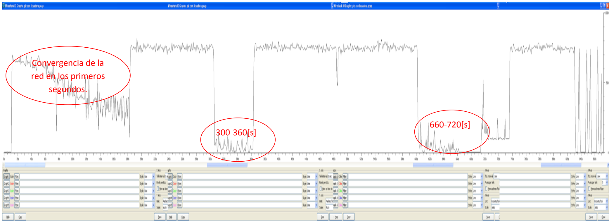
Figura 4.24 Gráfica del flujo de paquetes para la prueba de PLC con ruido electromagnético.
