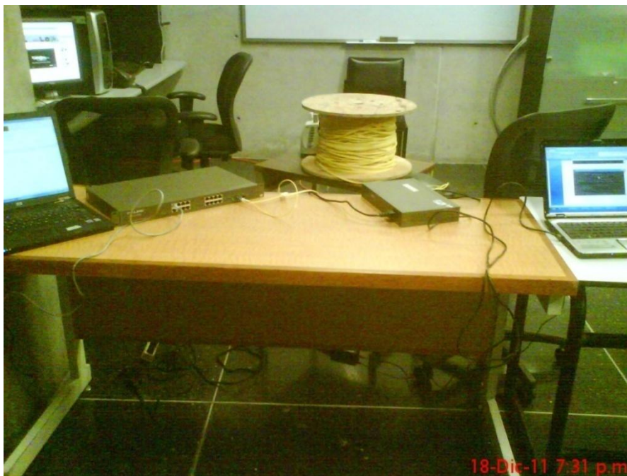
Figura 3.6 Implementación física de la red de Fibra Óptica con un cliente y un servidor
