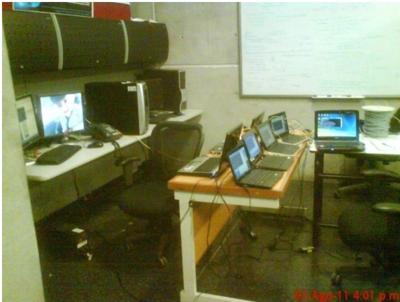
Figura 3.9. Implementación física de la red con cable UTP con 8 clientes y un servidor
