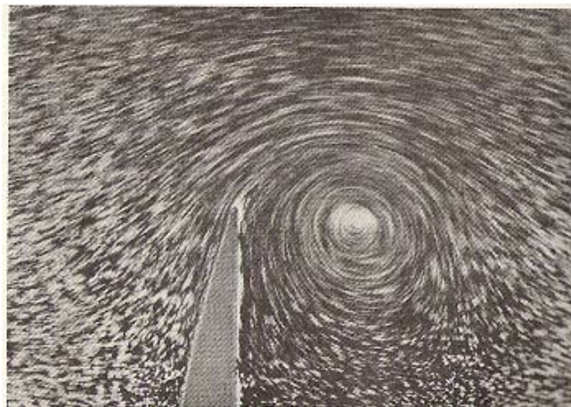
Fig. 3.46.- Flujo alrededor de un borde de cuchillo
