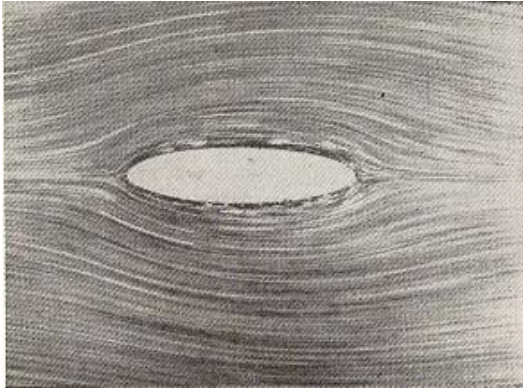
Fig. 3.72.- Flujo alrededor de un cilindro elíptico con eje menor d en w d/v = 1.30
