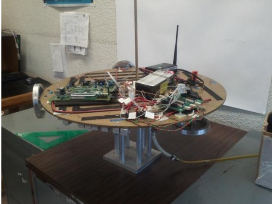
Figura 8.2 Tarjeta de drivers elaborada en esta tesis para Ruedas Inerciales sobre la MSA.
