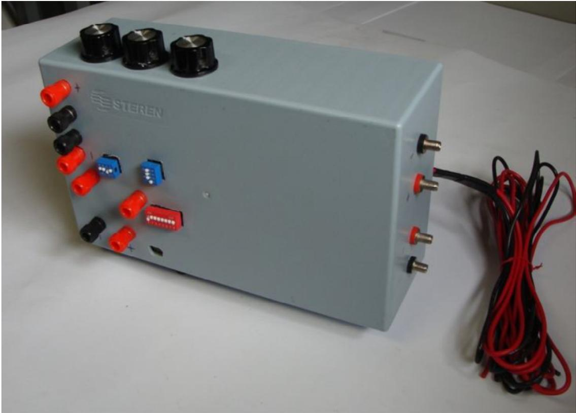
Fig. 3.24. Equipo transmisor óptico de 16 canales (Fotografía)
