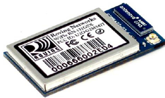
Figura 2.2 Vista real del módulo WiFly RN-131GSX.
