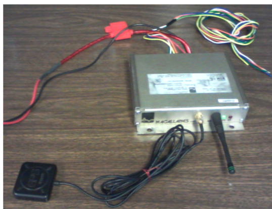
Figura 2.6 Vista real del controlador de abordaje en los vehículos de transporte Pumabús
