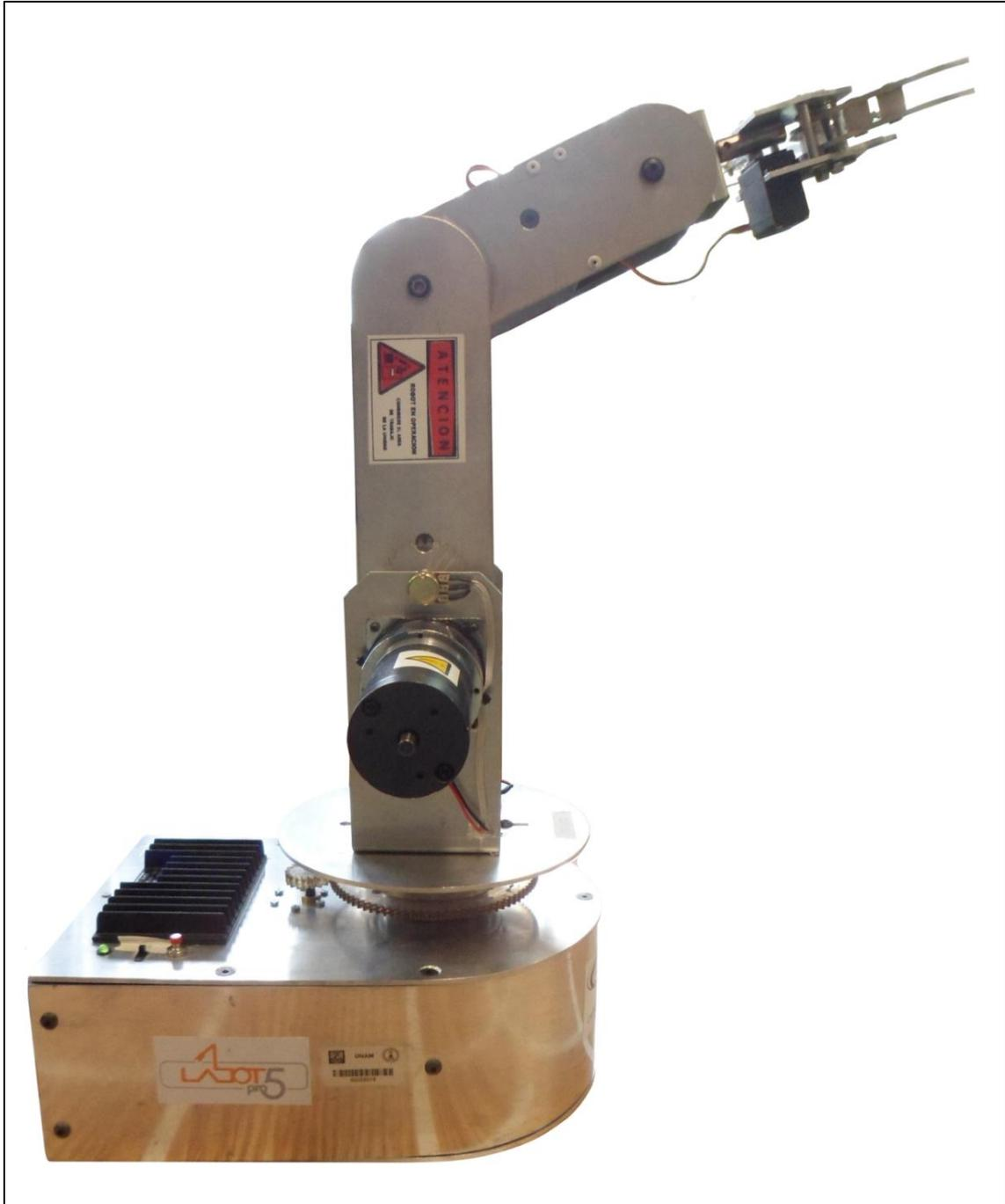
**Figura 3.1** Manipulador robótico antropomórfico Labot Pro 5.
