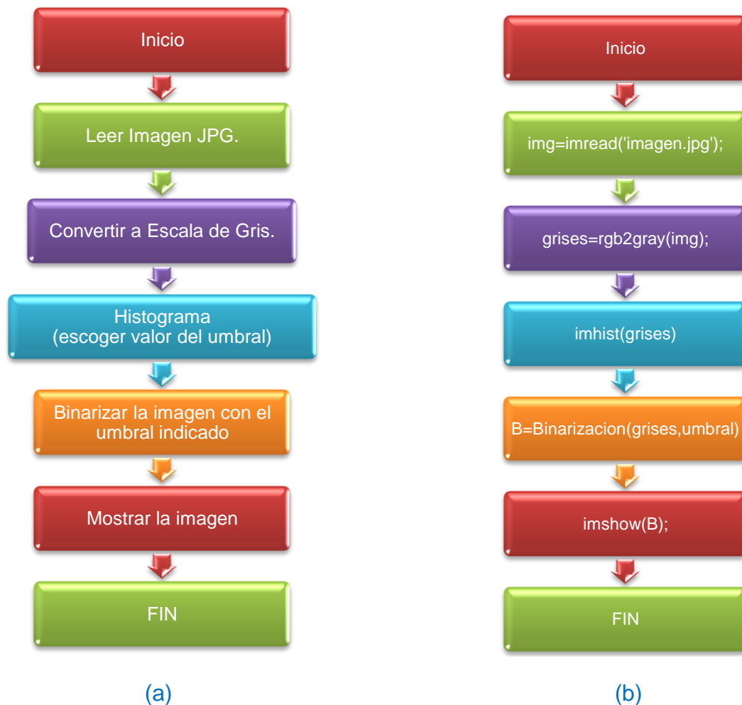
Figura 4.3. (a) Diagrama de flujo (b) algoritmo en Matlab para binarizar la imagen.
