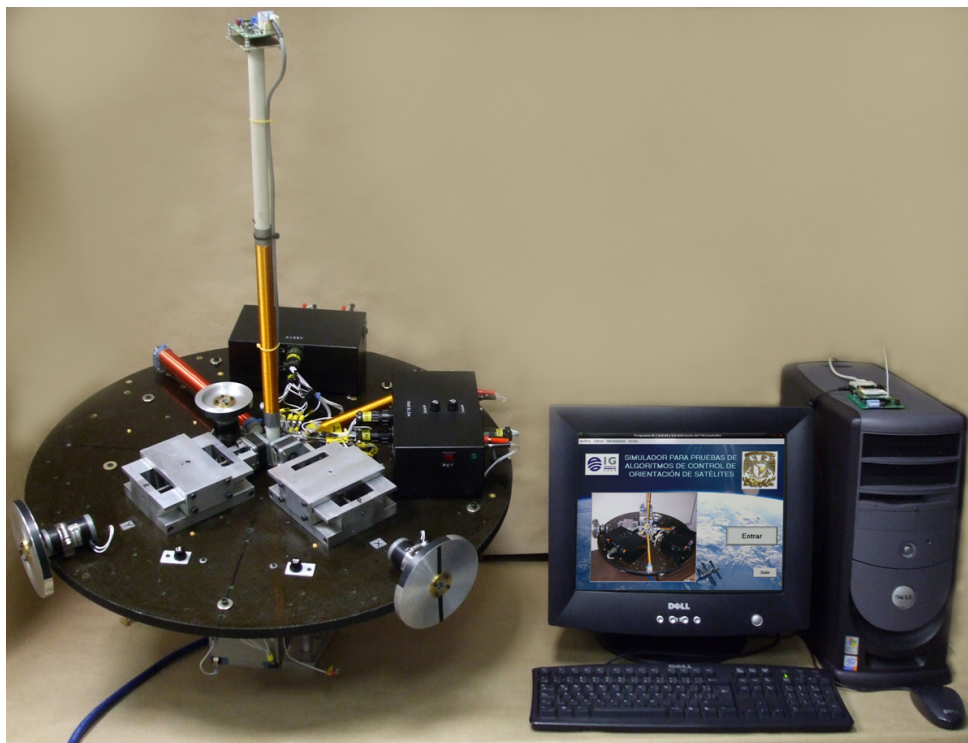
Fig. B.2. Sistema de simulación completo SIMUSAT_2.1, a la izquierda se encuentra la plataforma y a la derecha la estación terrena.
