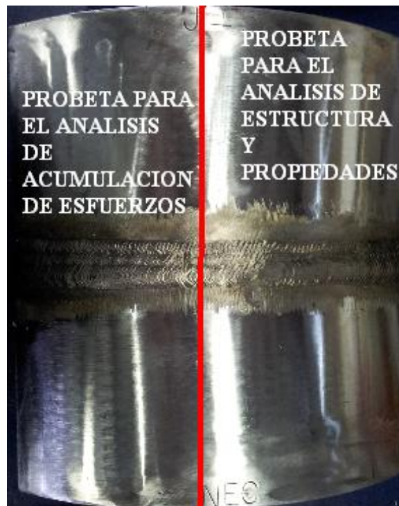
Fig. 15. Corte de probeta para análisis de acumulación de esfuerzos y caracterización de estructura y propiedades.
