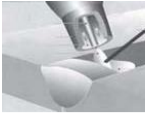
Fig. 8 Proceso de soldadura GTAW
