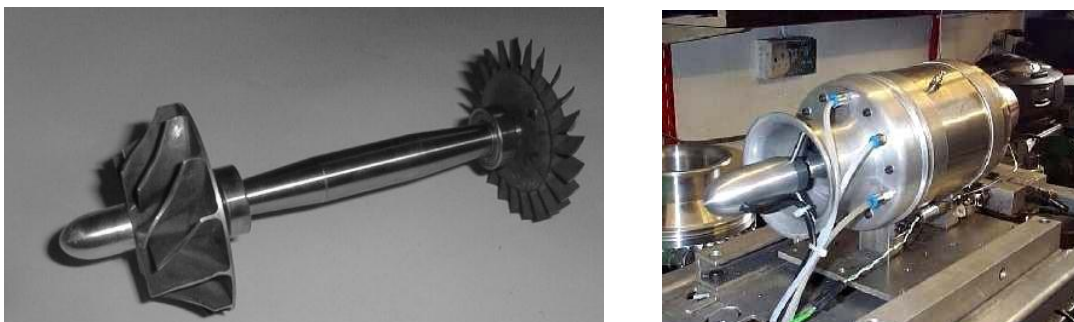
Figura 4. Compresor, turbina y flecha de una microturbina de gas con motor/generador integrado
