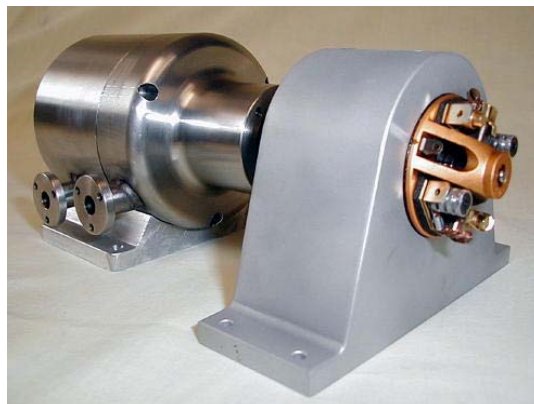
Figura 8. Carcasa y acoplamiento de un segundo generador eléctrico exclusivo para una turbina de vapor
