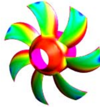
Figura 2.10. Modelo sólido de los alabes de un ventilador axial
