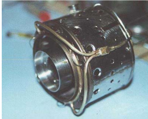
Figura 5. Cámara de combustión en una Microturbina de Gas
