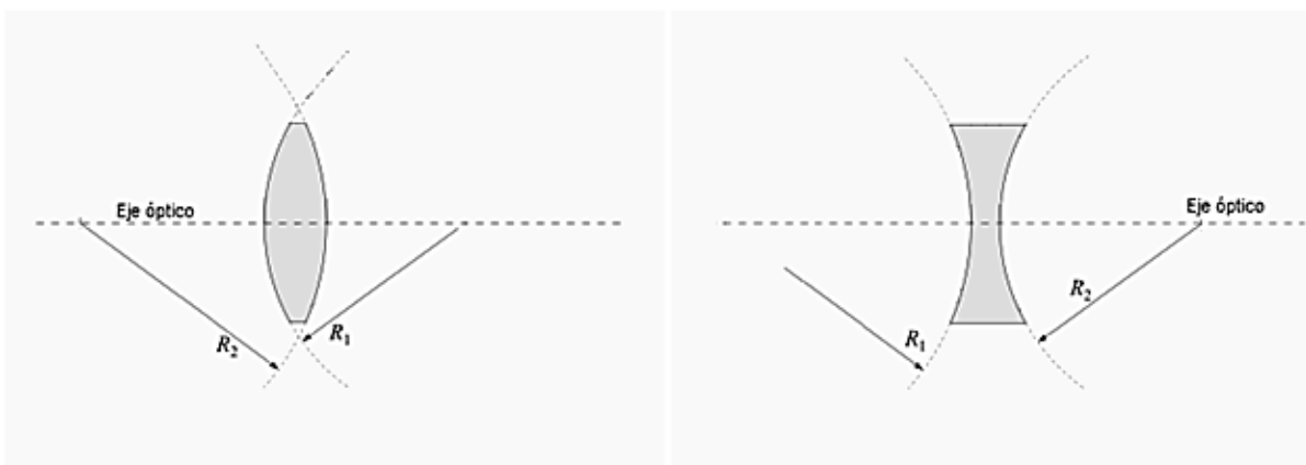
Figura 7. Eje óptico lente positiva y lente negativa.
