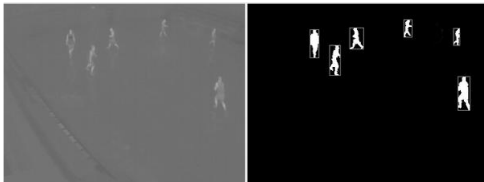
Figura 78. Detección de personas con métodos de procesamiento digital de imágenes. [21]
