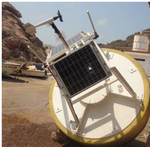
Figura 56. Boya montada para periodo de pruebas en tierra.
