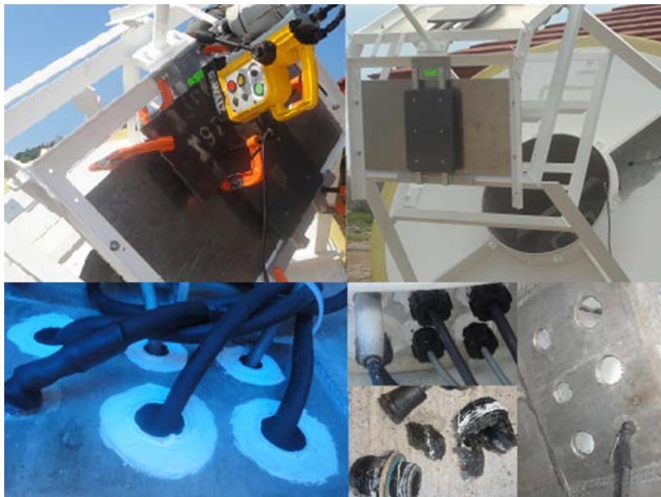
Figura 54. Montaje de la instrumentación en la boya. (Unidad académica de Mazatlán)
