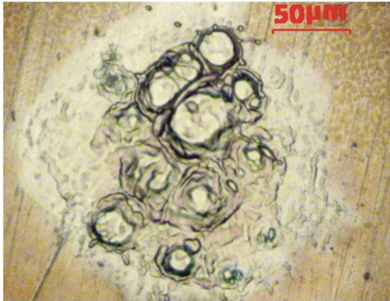
Figura d.1. Cráter producido por la ablación de una muestra de cobre metálico con un láser pulsado de 10 nanosegundos. Se observa el material redepositado y las crestas formadas.
