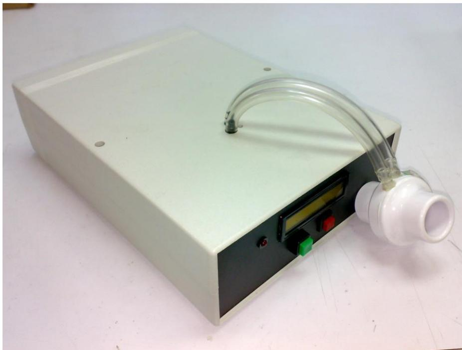
*Figura 42. Vista externa del Espirómetro de Flujo*
