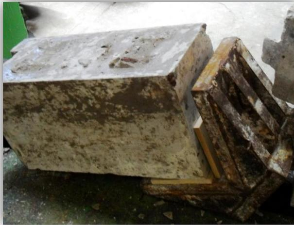
Block de contacto con el cabezal inferior, muestra que sus botones de ensamble fueron fracturados.
