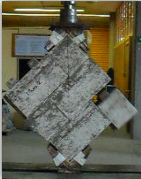
Desprendimiento de la pieza en el extremo horizontal del murete debido a que la diagonal horizontal crece, lo que provoca un empuje en la pieza y finalmente esta cae por gravedad.
