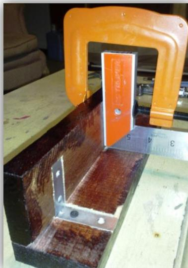
En el ensamblado del molde, fue de suma importancia cuidar la distorsión en las piezas que conforman al molde, para ello fue necesario resanar algunos detalles en la tapa anterior y posterior, así como en los laterales. La unión entre piezas se realizó con pijas para madera.
