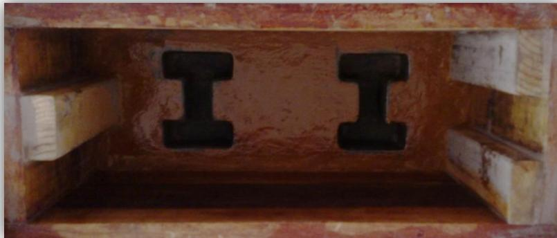
Para brindarle rigidez al molde de madera, se colocaron piezas de madera en sus esquinas, debidamente reforzadas y escuadradas. Estas piezas sirven también como guía en el instante de colocar la tapa.
