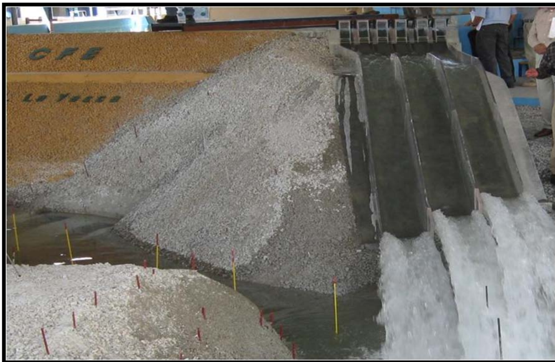
Figura 3.50. Modelo en Laboratorio del Vertedor del Proyecto Hidroeléctrico La Yesca.
