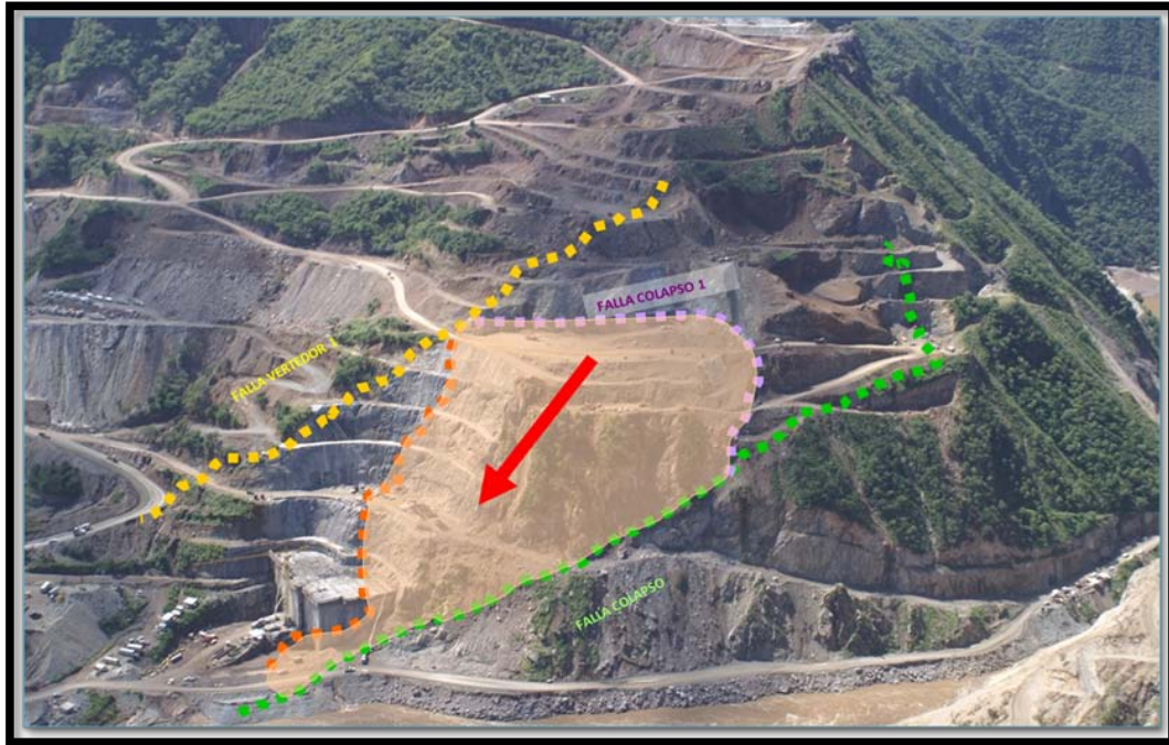
Figura 3.54. Principales Fallas Geológicas de la masa inestable de la Margen Izquierda (Marengo, 2008).
