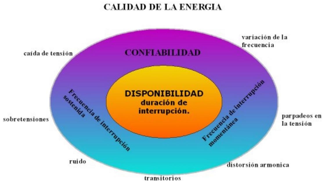
En la diagrama se visualiza a la disponibilidad como un subconjunto de la confiabilidad y la confiabilidad es un subconjunto de calidad de la energía. La calidad de la energía se refiere a cualquier desviación o modificación en la fuente de energía y produce como consecuencia una onda de tensión sinusoidal defectuosa. La confiabilidad se refiere a las interrupciones y la disponibilidad se refiere a la probabilidad de ser interrumpido.
