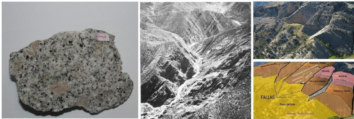
Figura 2.1 a) Estructura de la roca intacta, b) Masa rocosa discontinua, c) Falla e interpretación
