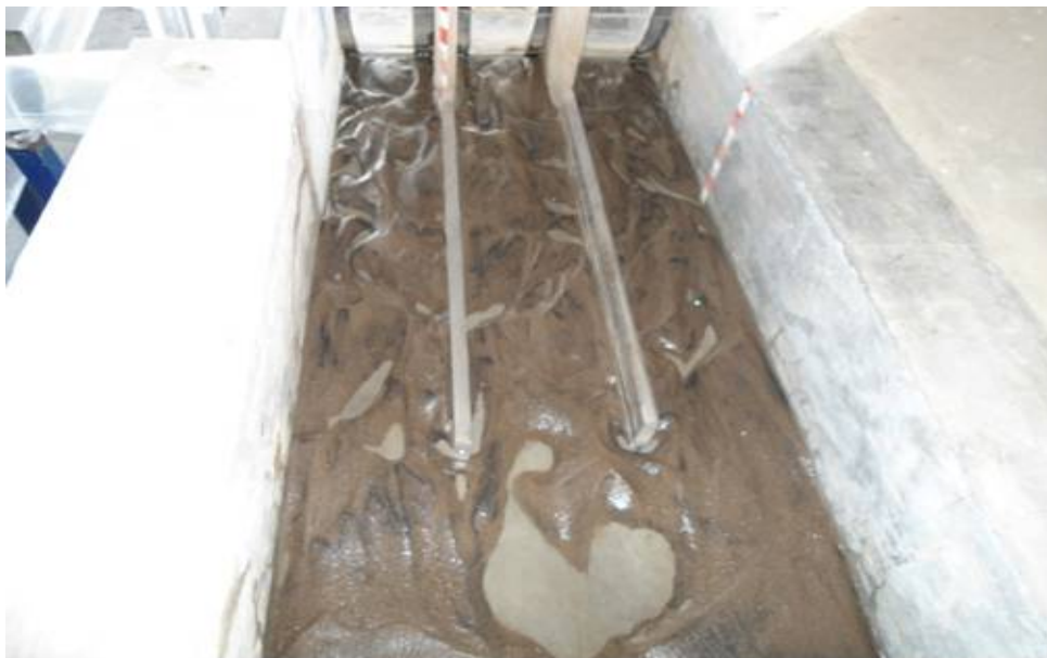
Figura 4.12 Funcionamiento del desarenador, arrastre de sedimento después de 2.23 hrs de prototipo, gasto 458 m 3 /s.
