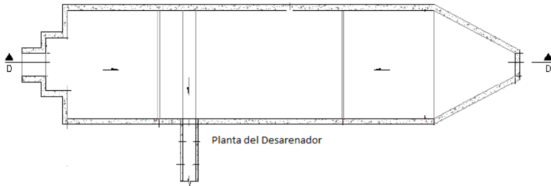
Figura 2.1 Desarenador tipo Horizontal, convencional, en planta.
