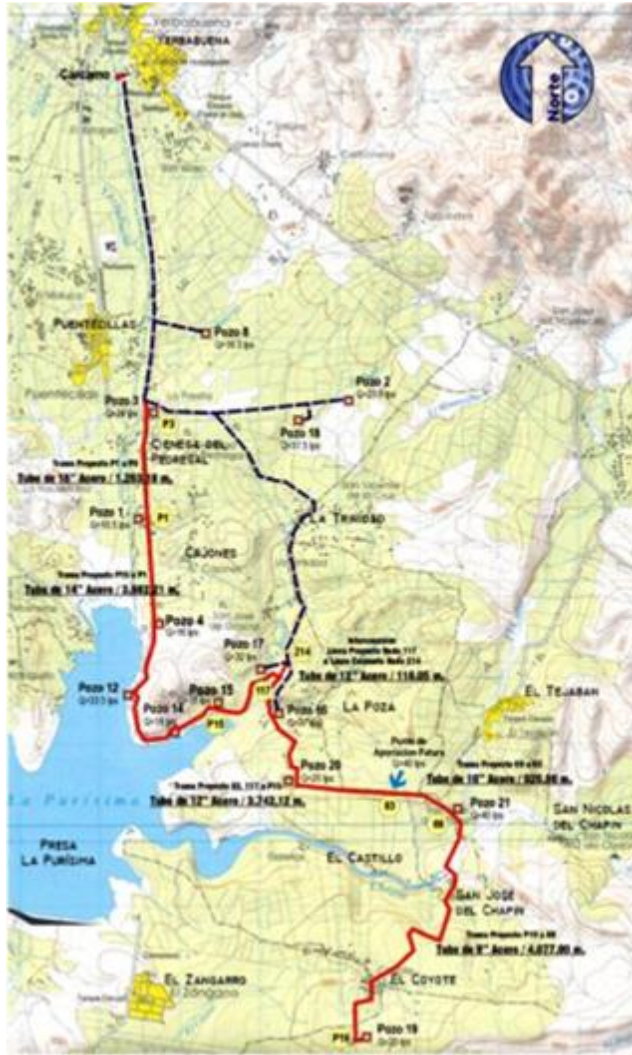
Figura 1.12 interconexión Sistema Puentecillas
