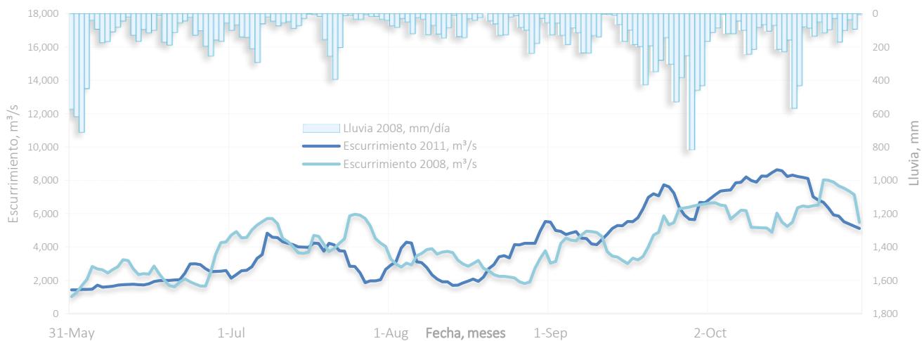
Figura 3.4 En este gráfico se muestran los hidrogramas medidos en la estación Boca del Cerro durante los eventos de inundación de 2008 y 2011, también se puede observar el registro de lluvia máxima diaria en la misma estación en 2008.
