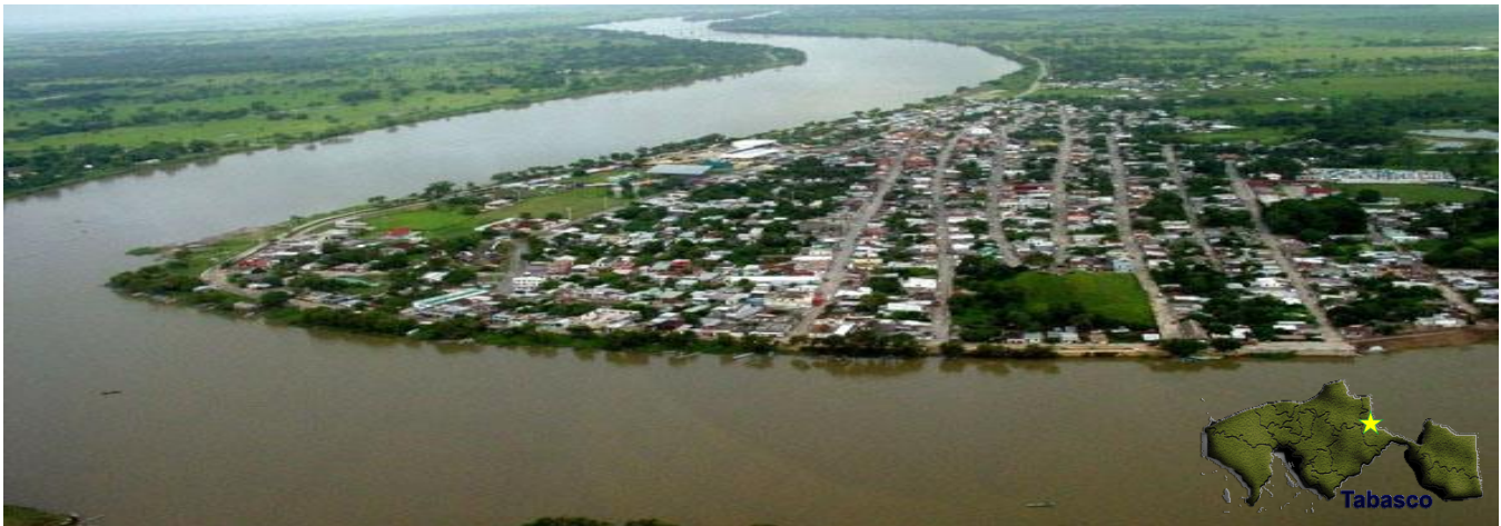
Figura 3.5 Río Usumacinta (localidad de Jonuta, 2011). Se observa que en ambas márgenes del río se tiene vegetación y el cauce principal en promedio es de 700 metros con una profundidad media de 20 metros, el fondo del río está compuesto principalmente por sedimentos finos y gruesos.
