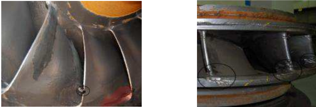
Figura 1.1 Abrasión por arena en las turbinas. Proyecto Hidroeléctrico Cahua
