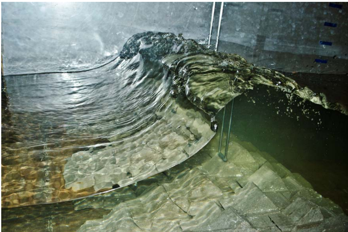
Figura 5. 11. Rotura deformada por la forma de la estructura.
