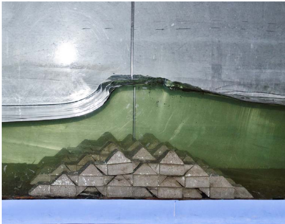
Figura 5. 13. Rotura de la ola deformada por la estructura (vista frontal).
