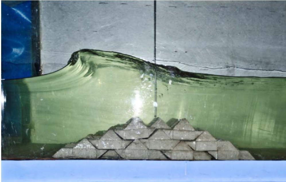
Figura 5. 12. Rotura de la ola deformada por la estructura (vista posterior).
