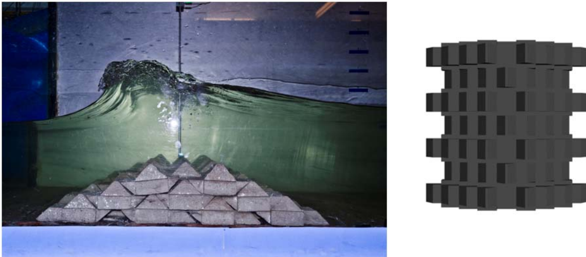
Figura 5. 24. Dique 2, visto en perfil (izq.) y visto en planta (der.)
