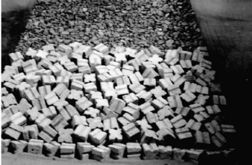
Figura 2. 17. Disposición arbitraria de bloques Antifer.
