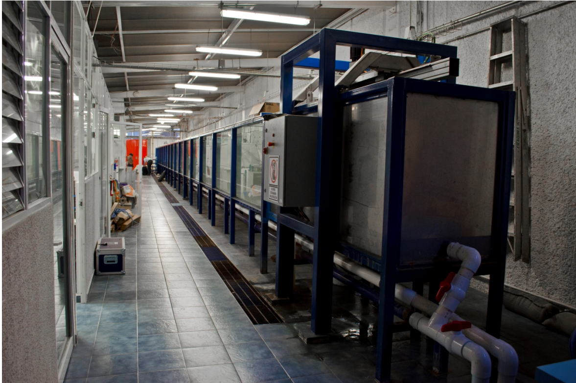
Figura 4. 8. Canal de oleaje de del laboratorio del GICyP
