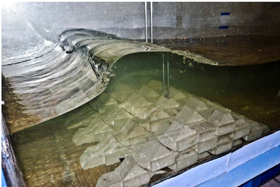
Figura 5. 10. Rotura del oleaje vista a detalle.
