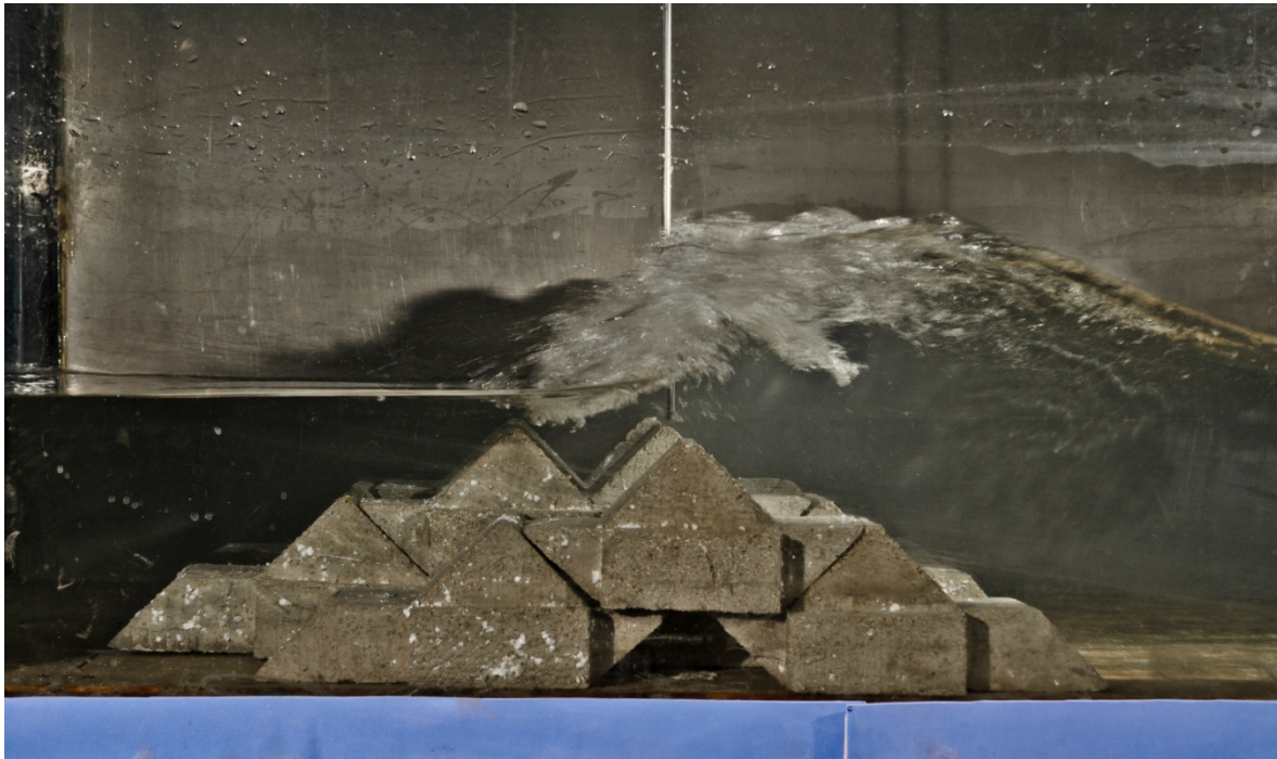
Figura 4. 13. Armado de la estructura, escala 1:10.
