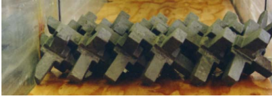
Figura 2. 11. Modelos a escala de “A-Jacks” para pruebas en canal de oleaje.
