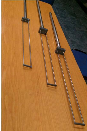
Figura 4. 9. Sensores de nivel.
