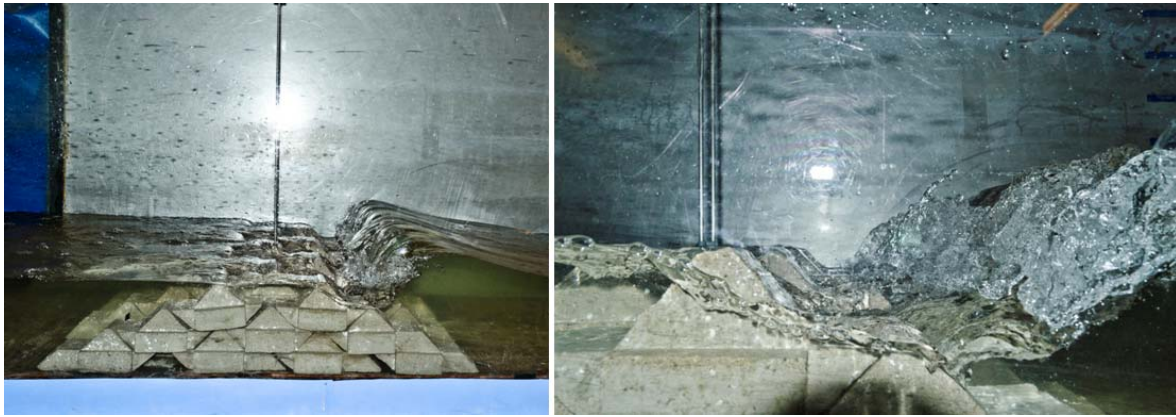
Figura 5. 8. Ola rompiendo sobre el talud de la estructura. H=4 cm, h=26 cm.
