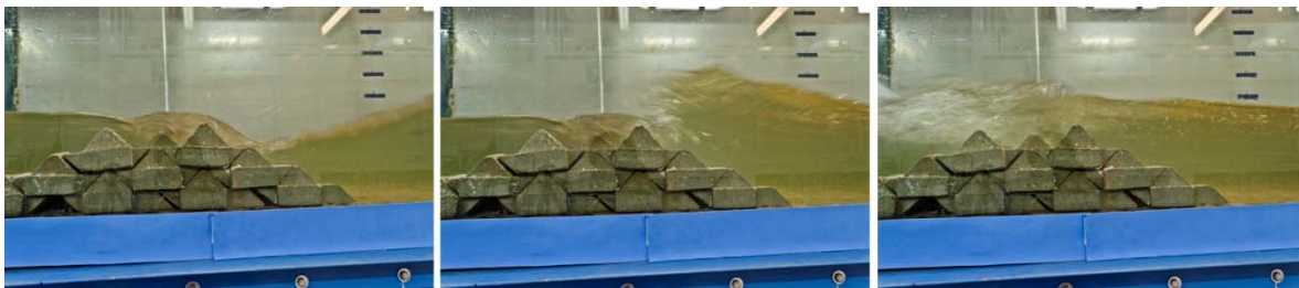
Figura 5. 7. Ola rompiendo cuando incide sobre la estructura. H=9 cm, h=30 cm.
