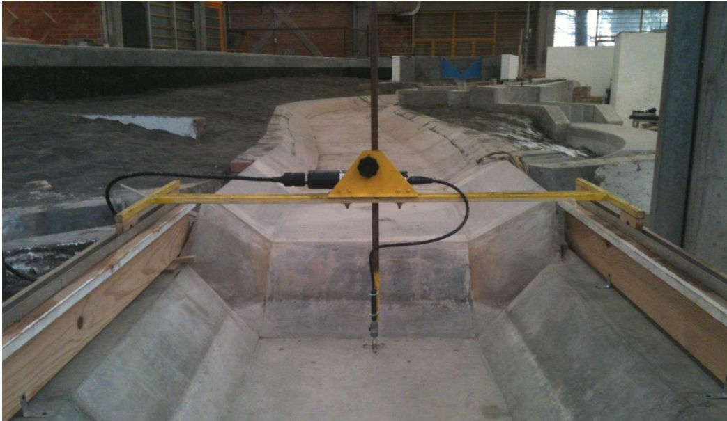
Figura 3.4 Posicionamiento y sujeción del ADV
