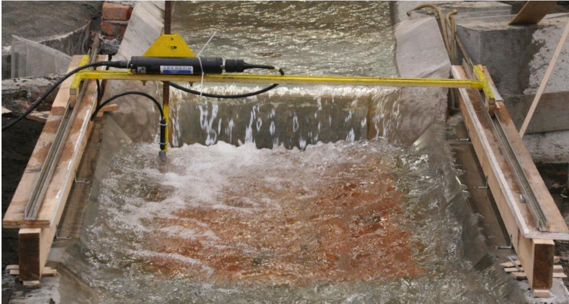
Figura 3.5 Registro de señales de velocidad con ADV
