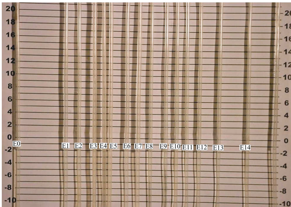
Figura 4.3 Tablero de manómetros
