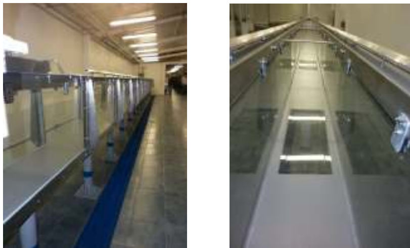
Figura III-1 Canal de oleaje
