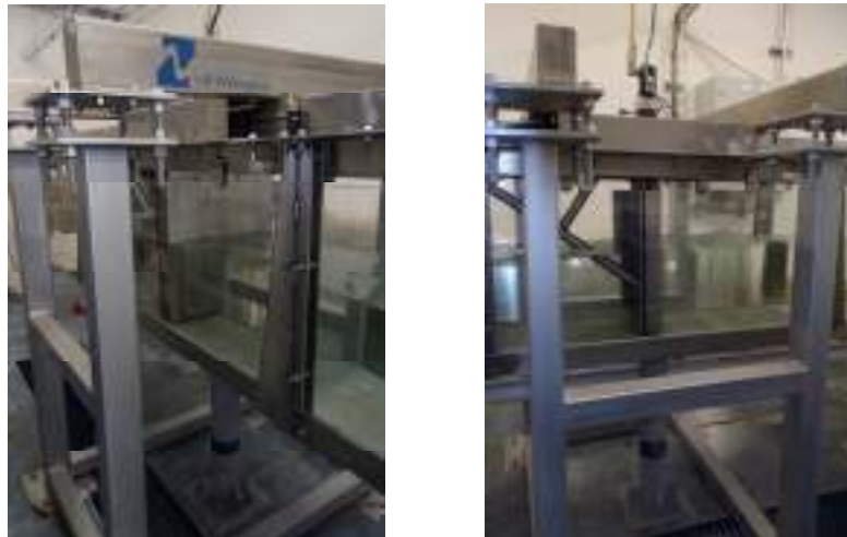
Figura III-2 Pala generadora de oleaje
