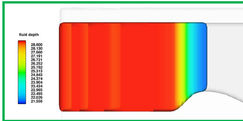
Figura 4.15 Condiciones Iniciales para Modelación del Gasto de 5 037 m 3 /s
