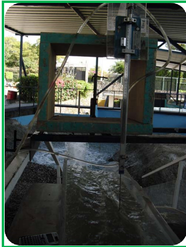
Foto 3. Obtención del tirante sobre el eje una canal con Limnómetro (Laboratorio de Hidráulica CFE)
