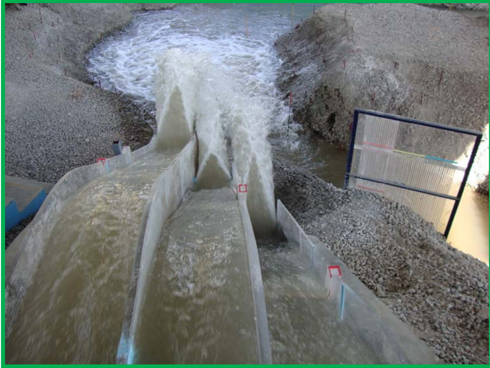
Foto 2.3 Vista superior del efecto de los deflectores en la estructura terminal del modelo Le=75 del vertedor del P.H La Yesca (Fuente Lab. Hid. - CFE).
