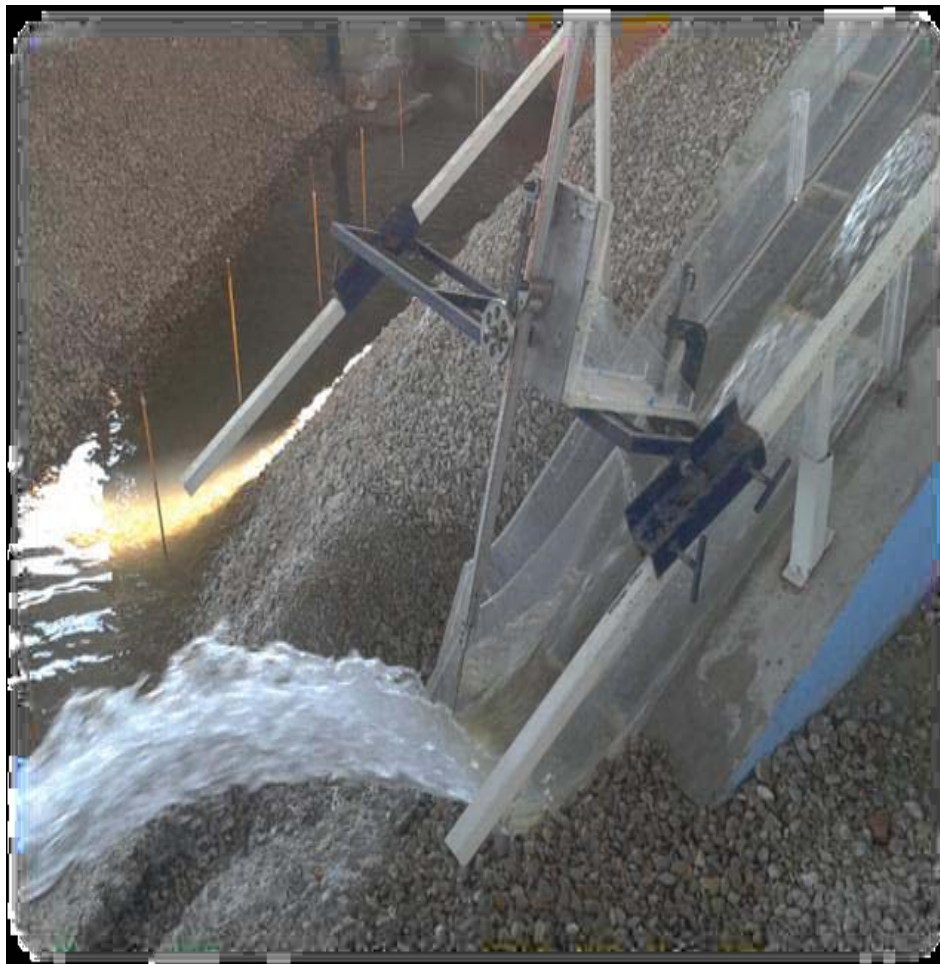
Foto 3.1 Medición con Tubo Pitot en modelo (Fuente CFE)
