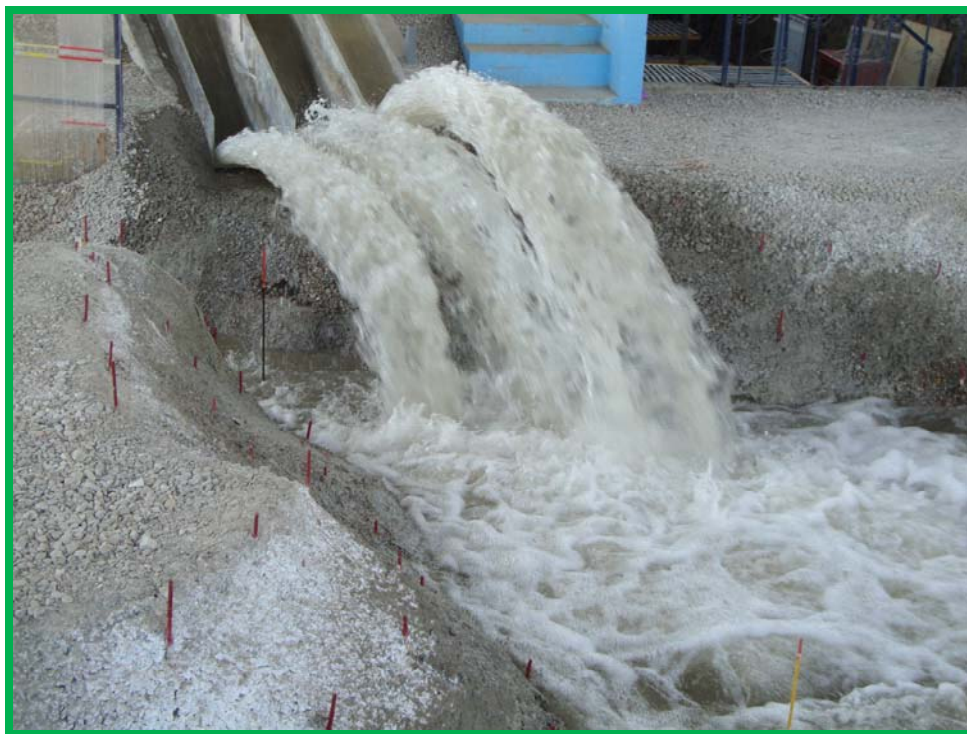
Foto 2.4 Vista frontal del efecto de los deflectores en la estructura terminal del modelo Le=75 del vertedor del P.H La Yesca (Fuente Lab. Hid. - CFE).
