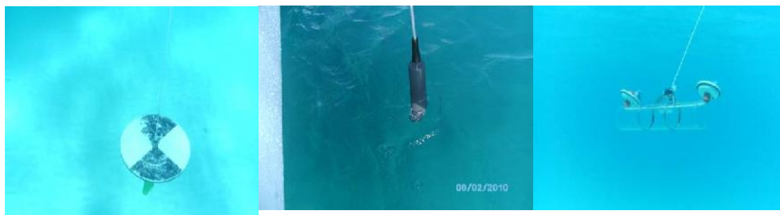
Fig.4.38 Dispositivos de medición en la primera imagen se puede observar el disco de Secchi . Fotografías tomadas por personal de CFE.
