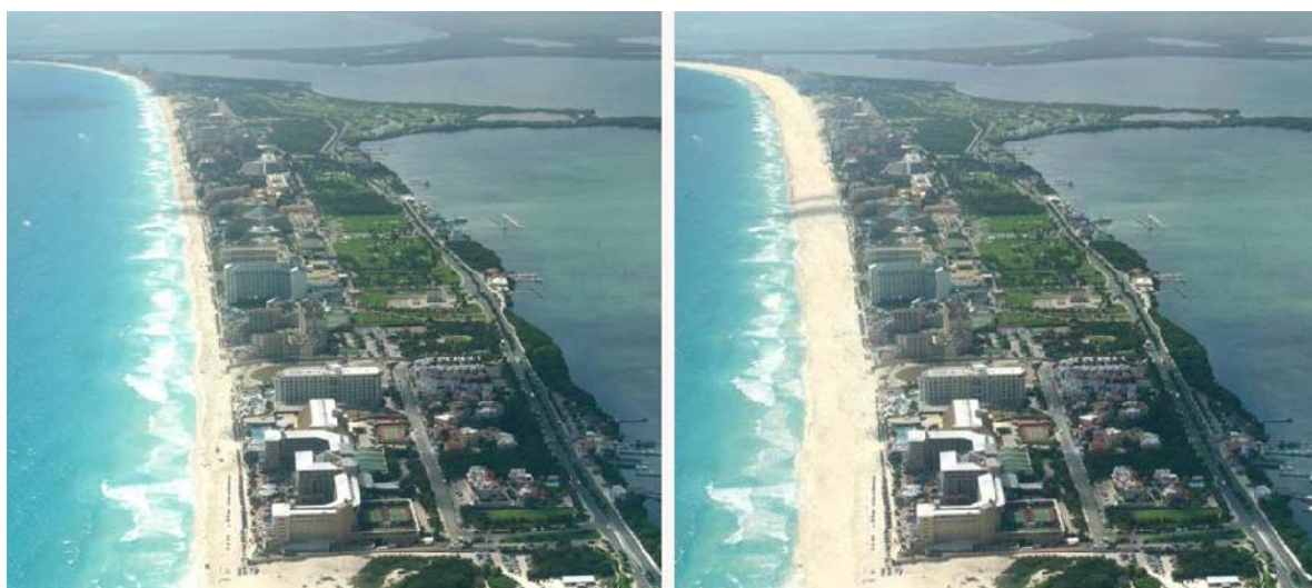
Fig.4.35 Vertido de arenas para la Restitución de Playas Nizuc-Cancún, sin obras de cierre adicionales. Fuente: Dictamen Técnico y Manifestación de Impacto Ambiental para el proyecto de restitución de playas de Cancún.
