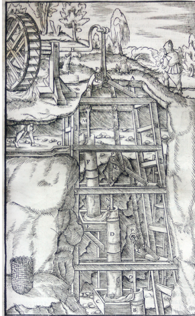
Figura B.1.3 Sistema de bombeo de tres tiempos empleado en el S XI para contralar el flujo de agua en minas (tomado de Shelton, et al. 1956)
