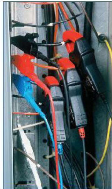
Mide el voltaje y la corriente de las tres fases simultáneamente.
