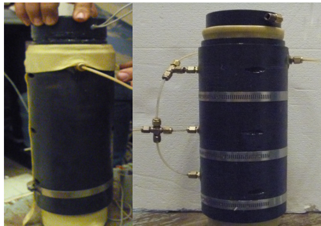
b) Colocación y aseguramiento cabezal Figura 3.4 Colocación de cabezal.
