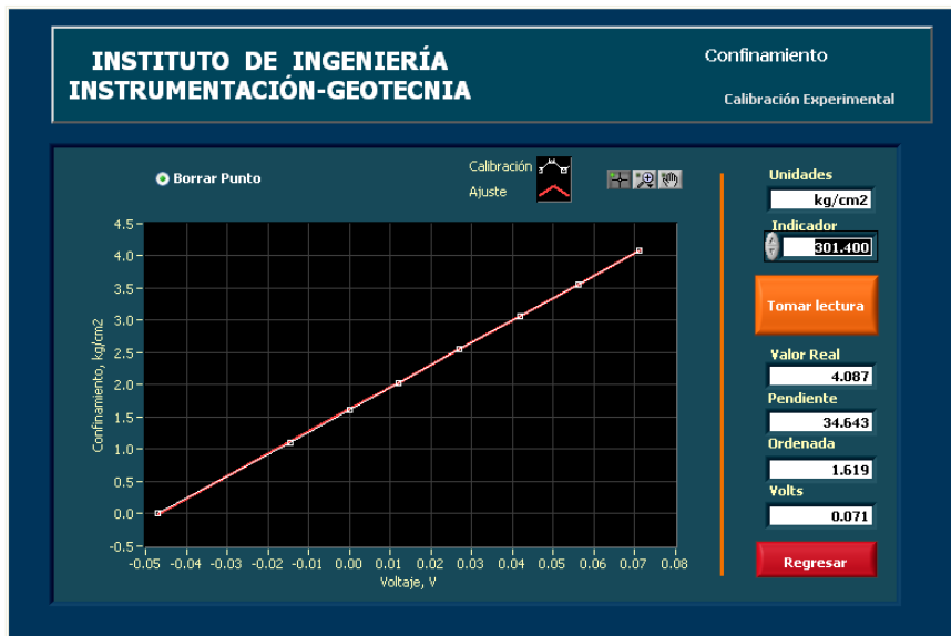
Figura 2.15 Calibración de un sensor de desplazamiento.
