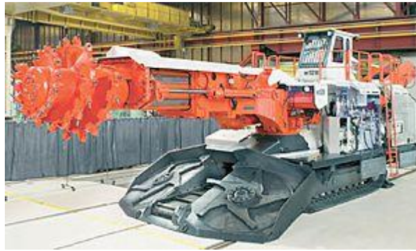
Fig. 1.12. Rozadora empleada en la excavación por ataque puntual.
