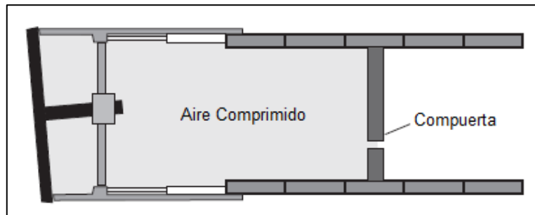
Fig. 1.22. Esquema de un escudo a presión de aire.
