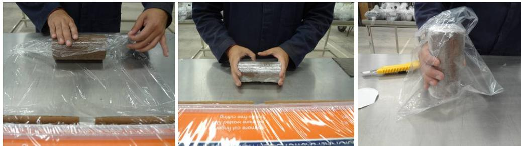
**Figura 4.26. Empaque de especímenes compactados.**
