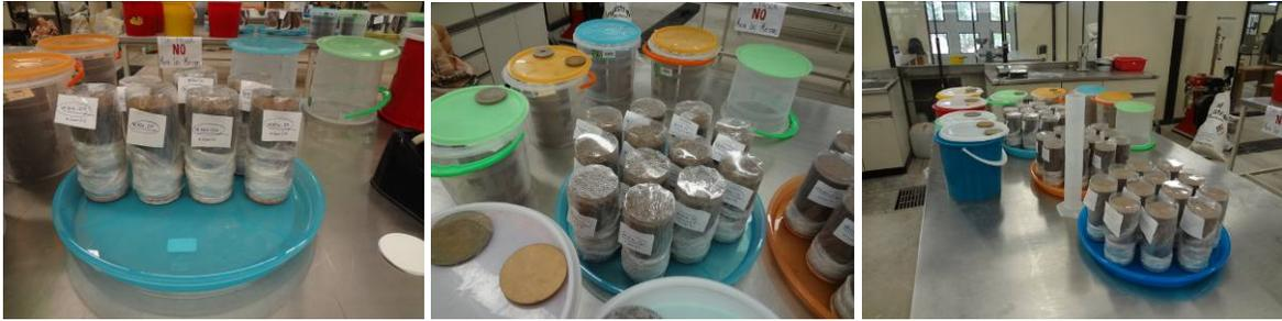
**Figura 4.30. Acondicionamiento de especímenes (trayectoria de humedecimiento).**
