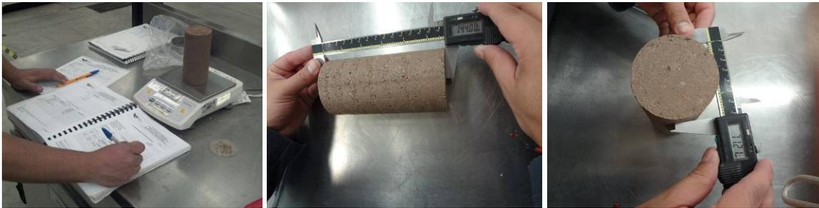
**Figura 4.25. Pesaje y medición del espécimen compactado.**
