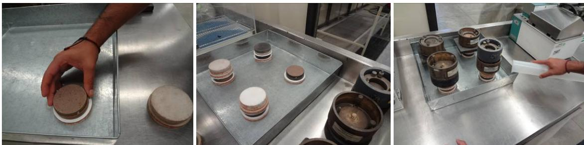
**Figura 4.43. Proceso de saturación del espécimen de prueba.**
