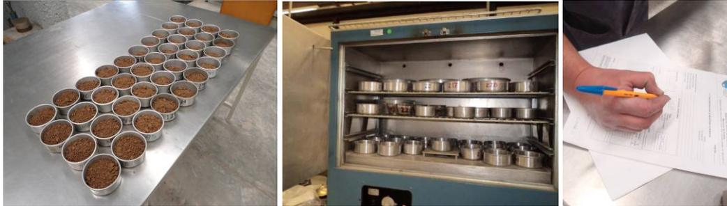
**Figura 4.27. Verificación de las condiciones de compactación.**
