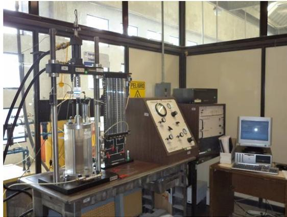
**Figura 4.1. Unidades que componen el equipo triaxial cíclico.**
