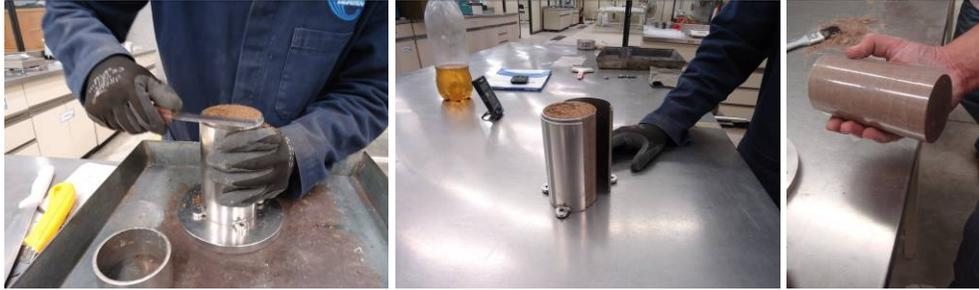
**Figura 4.24. Enrase y extracción del espécimen de prueba.**
