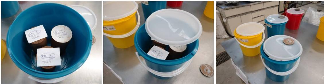
**Figura 4.28. Acondicionamiento de especímenes (trayectoria de secado).**
