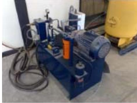
**Figura 4.4. Sistema hidráulico para la aplicación de cargas.**
