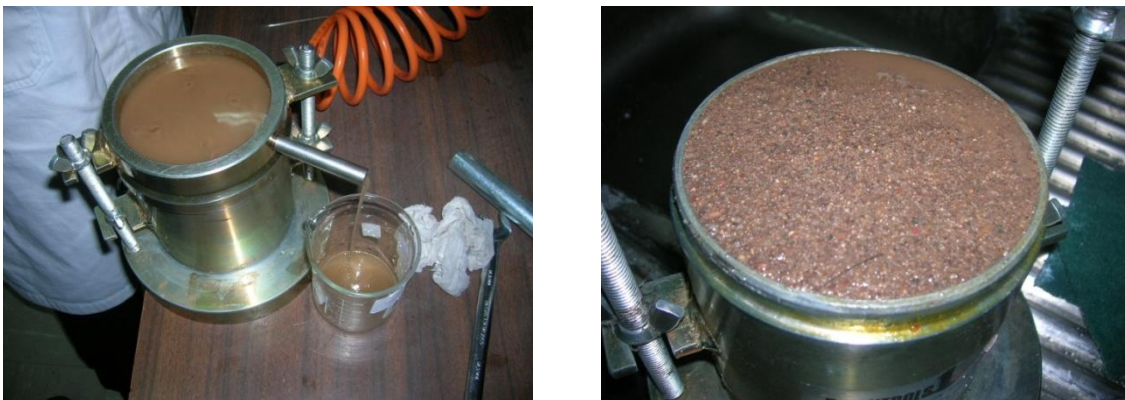
Figura 5.11. Prueba de permeabilidad [Juárez, 2008]
