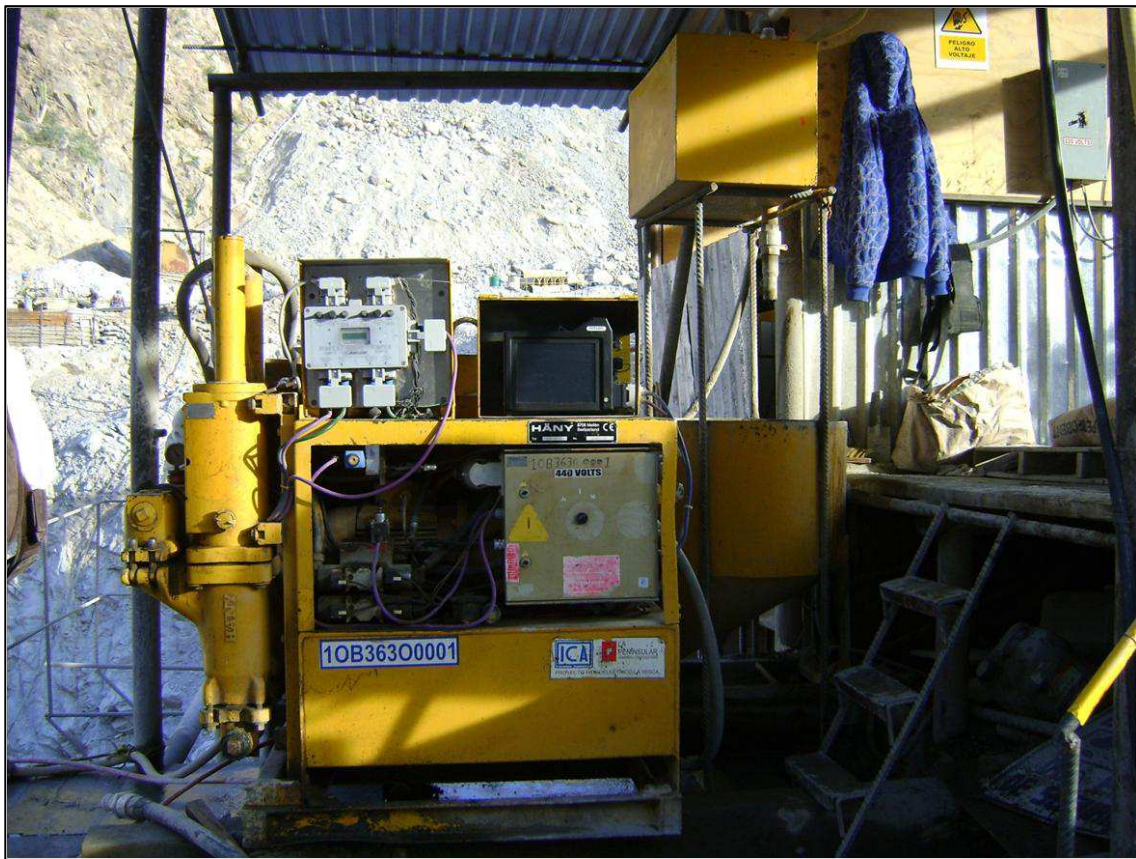
Fotografía 6.5. Equipo de inyección tipo Häny con turbo mezclado de altas revoluciones.
