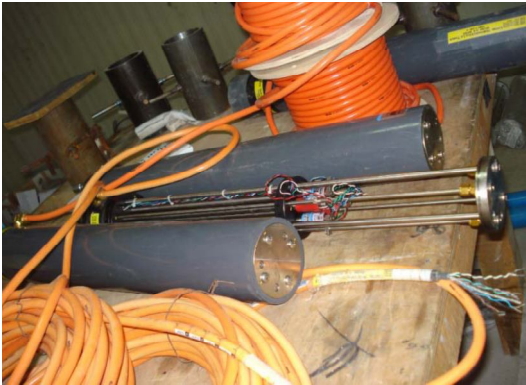
Fotografía 4.1. Extensómetro de barra.
