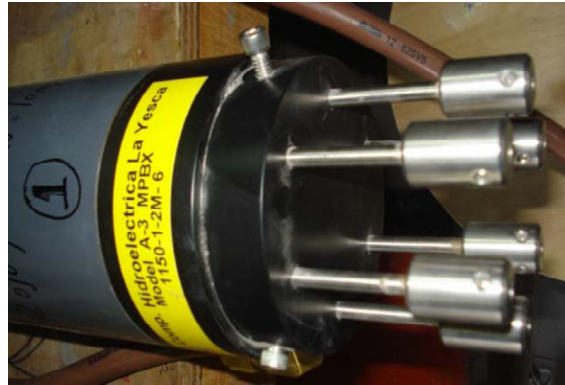
Fotografía 4.2. Cabezal de extensómetro de barras.
