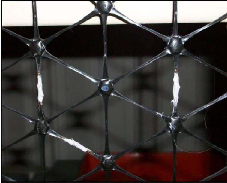
**Foto 3** Medidores instalados en la geomalla.
