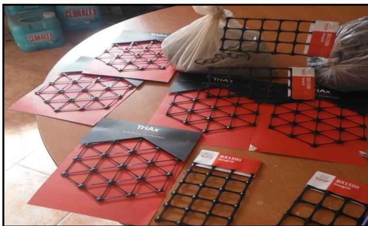
**Foto 18** Geomallas utilizadas en los ensayos (marca Tensar).
