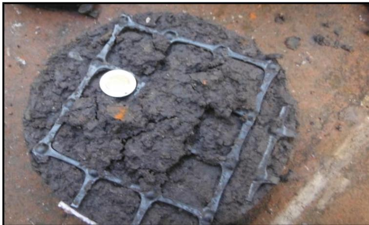
**Foto 17** Especímenes probados con dos materiales. (CH/SP-SM).
