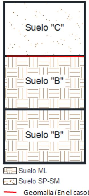
**Figura 4.22** Especímenes probados con dos materiales. (ML/SP-SM).
