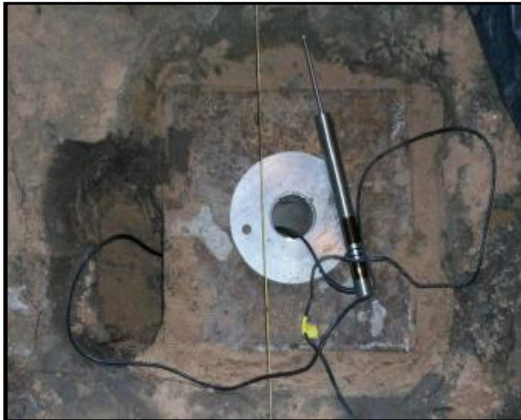
**Foto 5** Medidores instalados de deformación a profundidad.
