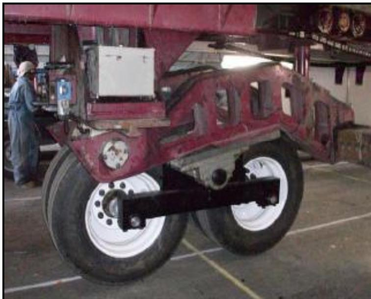
**Foto 7** Aplicación de carga con eje tándem.
