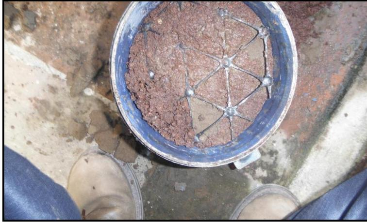
**Foto 16** Especímenes probados con dos materiales. (ML/SP-SM).
