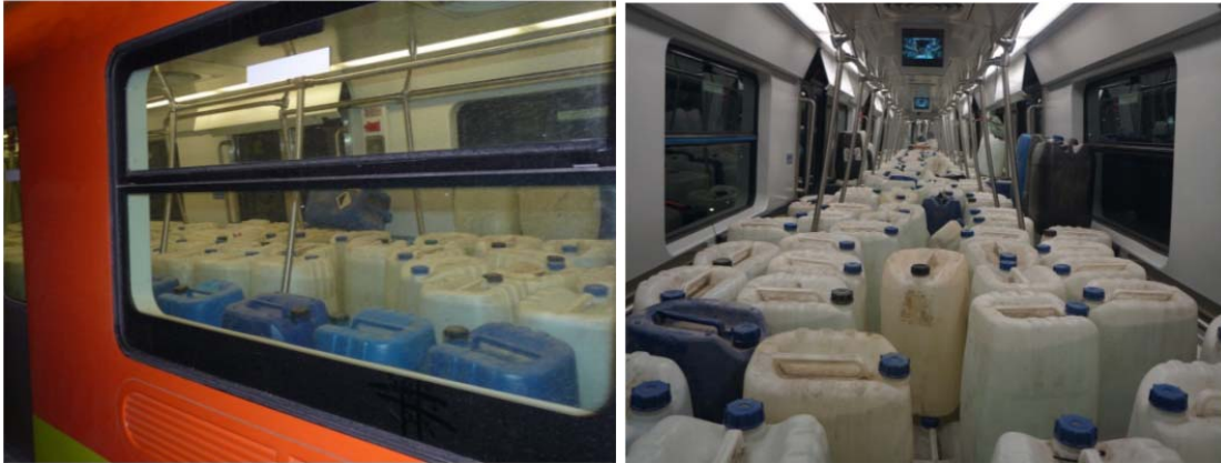
Figura 22. Vagón tipo FN lastrado con bidones de agua
