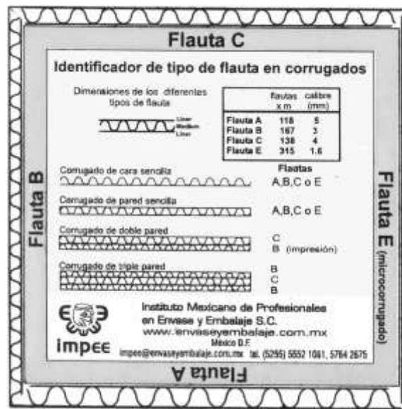
Ilustración 18.- Identificador de tipo de flauta en corrugados. 12
