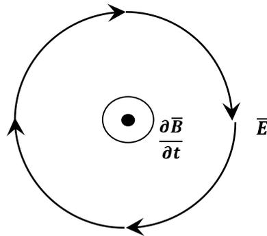
**Figura 2.1.** Representación de la circulación del campo eléctrico alrededor de la densidad de flujo magnético (Ley de Faraday).
