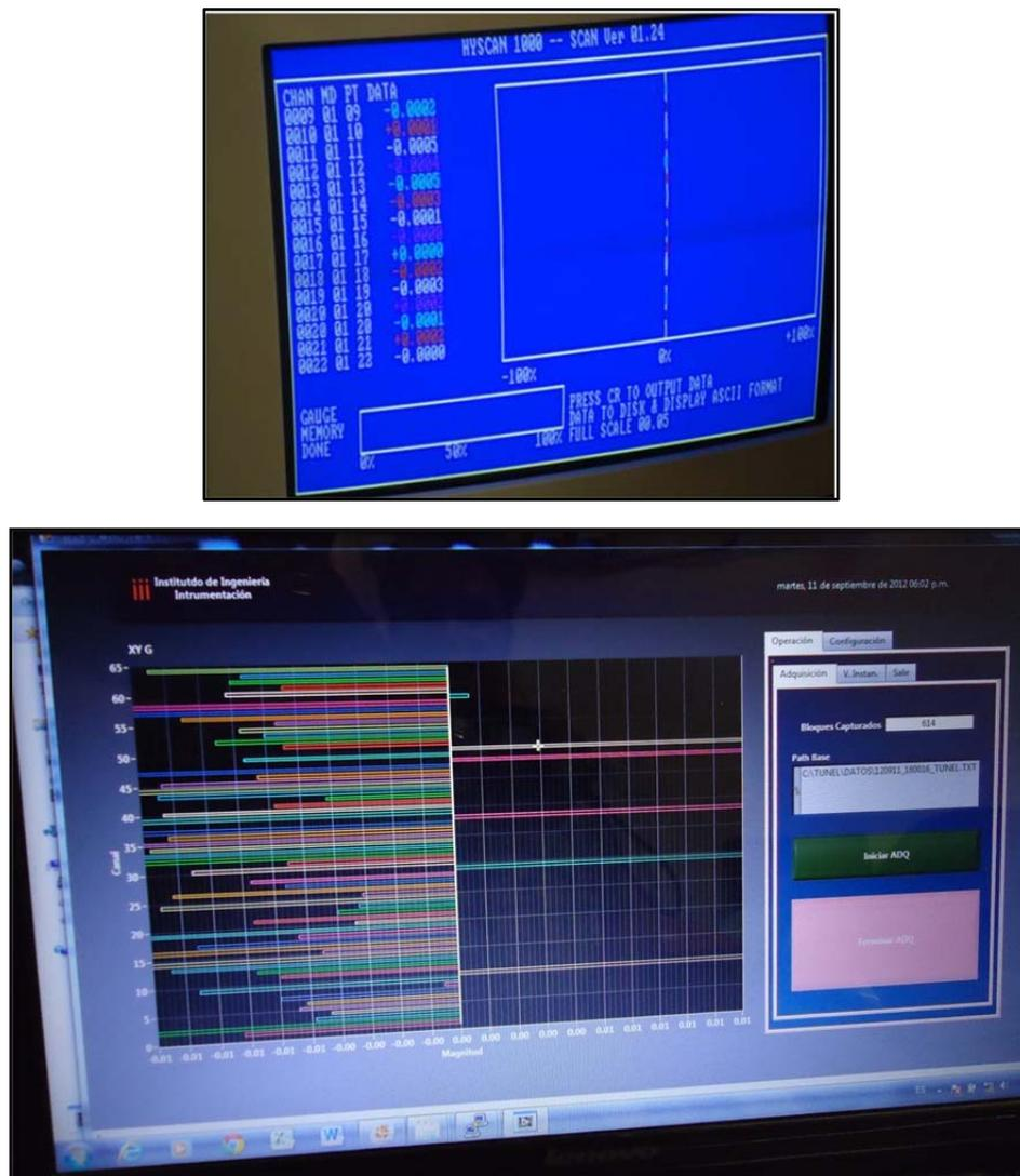
**Fig. 3.9 Equipo de adquisición de datos HYSCAN 1000 (parte superior) y sistema de registro desarrollado en IIUNAM (parte inferior)**
