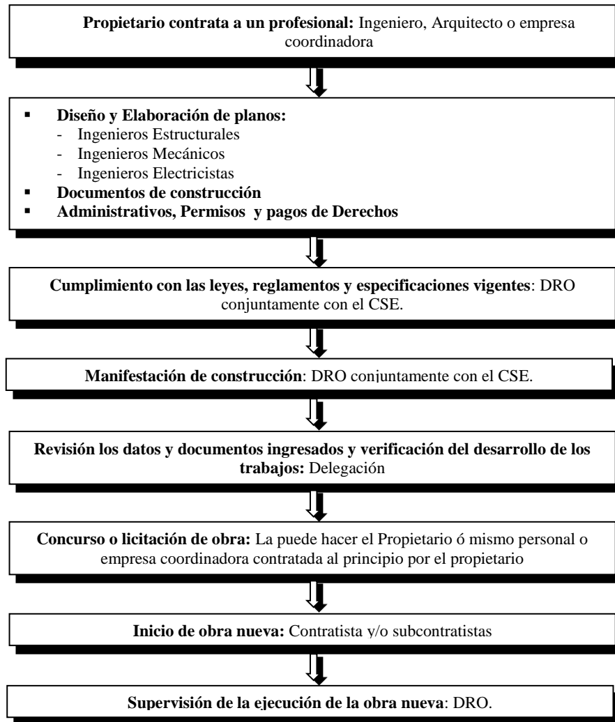
Figura 2.1 Sistema básico para obtener seguridad estructural en las edificaciones en la Ciudad de México
