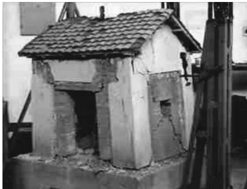
Figura 3.14. Ensayo de laboratorio de una estructura conformada por muros de mampostería confinada
