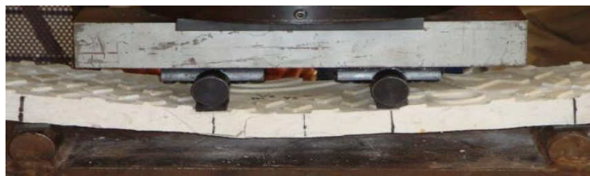
Figura 8.4 Muestra fallas paralelas.
