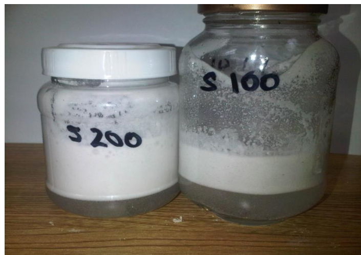
Fig. 6.9 Mojado de micro-esferas y precipitación. En este caso el efecto fue mayor en las micro esferas M200S de tal forma que al final se observa la formación de una pasta en este tipo de Microsil.
