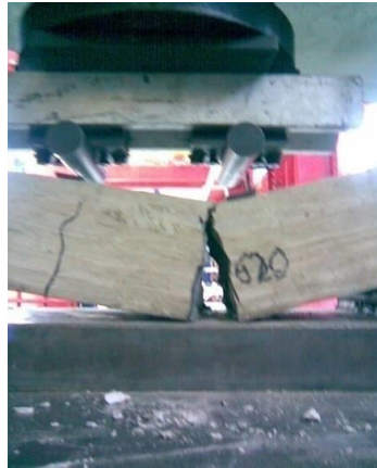
Fig. 8.7 Fotografía que muestra el ensayo del elemento de concreto hidráulico reforzado con malla electro soldada 10-10.
