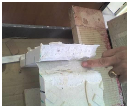
Figura 8.3 A y 8.3 B En las siguientes fotografías el desprendimiento del material se ve el desprendimiento del material en capas.
