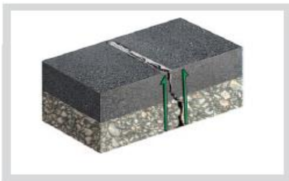
Figura 1.13 Las grietas migran hacia la superficie en la sobrecarpeta no reforzada 31 .
