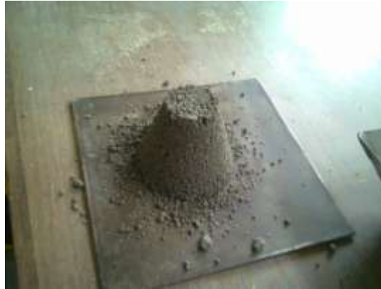
Figura 37. Retiro de cono. La muestra se mantiene íntegra
