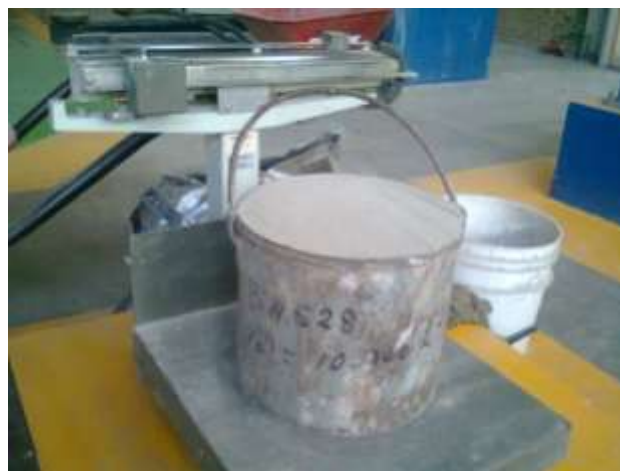
Figura 29. Obtención del peso de la arena
