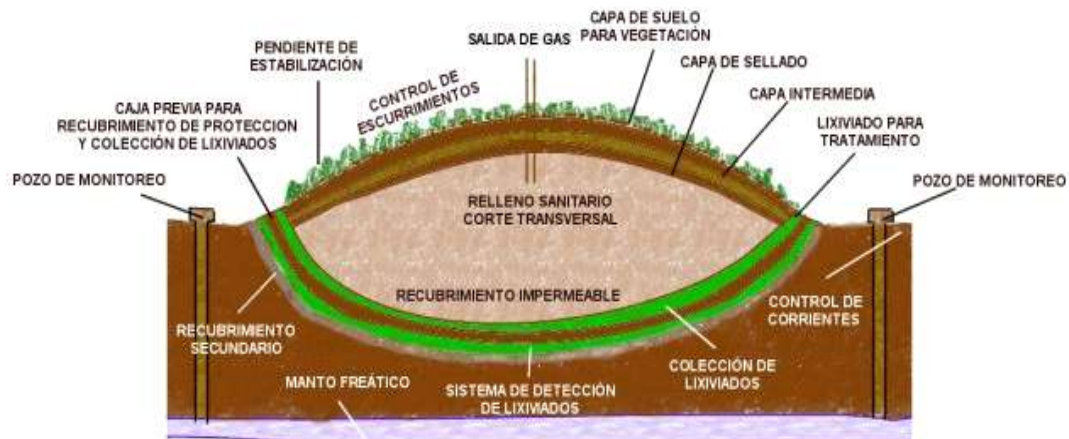
Figura 6. Esquema de un relleno sanitario
