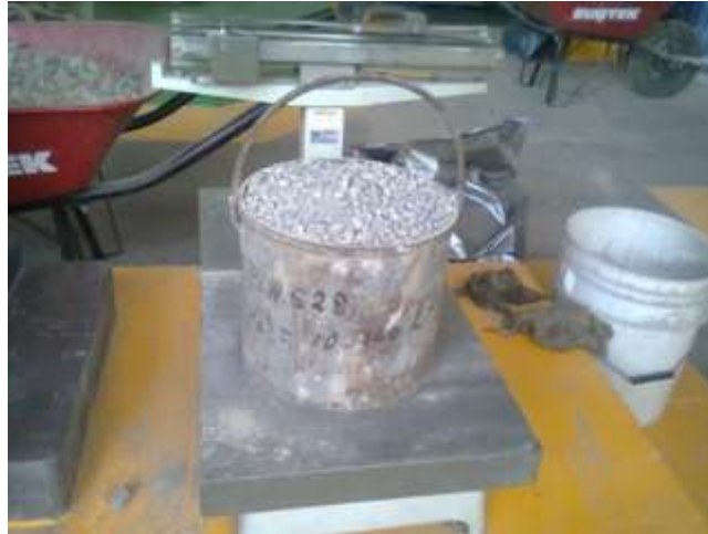
Figura 28. Obtención del peso de la grava
