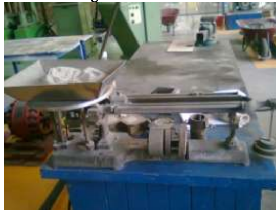
Figura 30. Preparación para obtener el porcentaje de humedad en la arena
