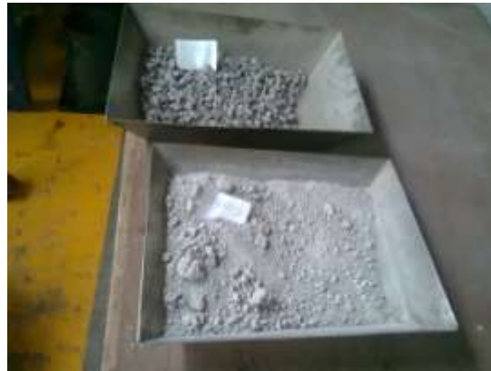
Figura 39. Muestras de grava y arena después de 24 horas en el horno
