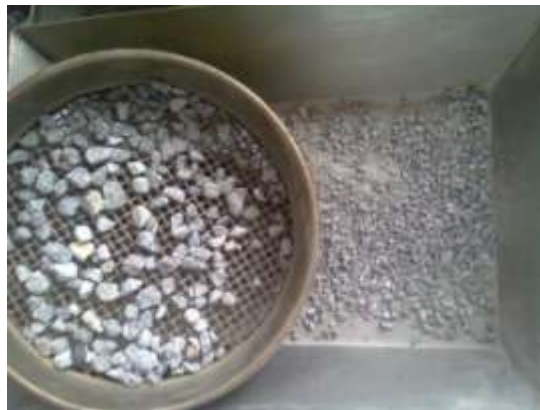
Figura 40. Vista de la malla y del material retenido y que pasa a través.
