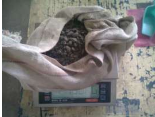
Figura 33. Secado y pesado de la muestra de grava.
