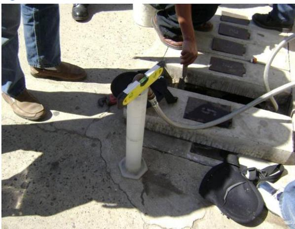
Figura 4.7. Medida volumétrica graduada para flujos bajos
