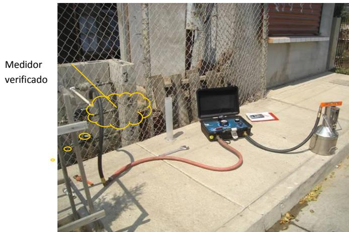
Figura 4.4. Configuración de equipo de prueba de medidores domiciliarios.
