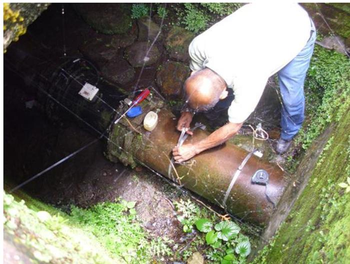
Figura 3.7. Evaluación del medidor electromagnético en la presa de cinco palos.
