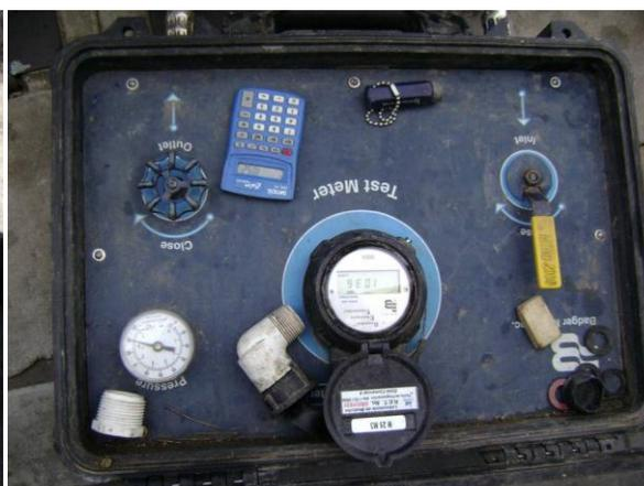
Figura 4.6. Probador portátil de medidores.
