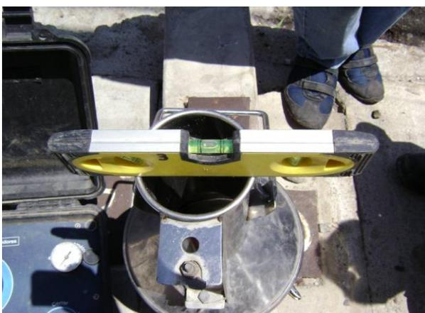
Figura 4.5. Nivelación de la medida volumétrica.
