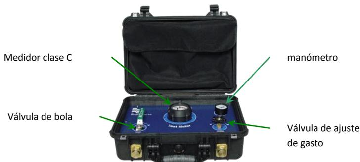
Figura 4.1. Probador portátil de medidores.
